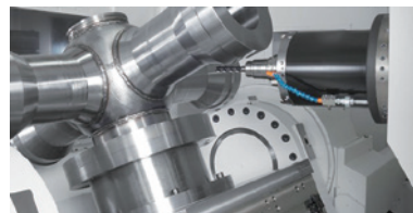
5軸加工機(多面体・複雑形状・精度の厳しい製品、ワンチャックにて加工)
