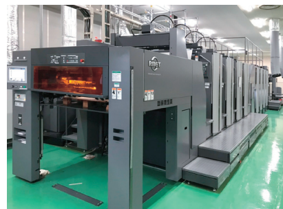
検査装置搭載菊全両面 4 色 UV オフセット印刷機
