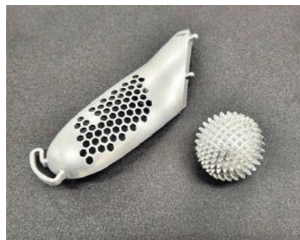
特注コントローラーカバーと三方向自由回転「球状歯車」
