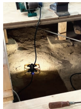
小型ドローンによる文化遺産 の床下点検の様子
