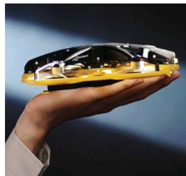
超狭小空間点検用ドローン IBIS2
