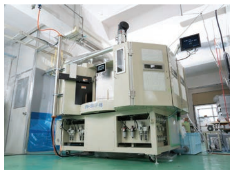
環境対策型コンパクト塗装機 省エネルギーで小ロット多品種生産を実現
