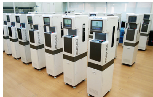
半導体設備投資の課題を解決する超小型半導体製造システム「ミニマルファブ」（写真は産総研にあるミニマルファブ推進機構所有）
